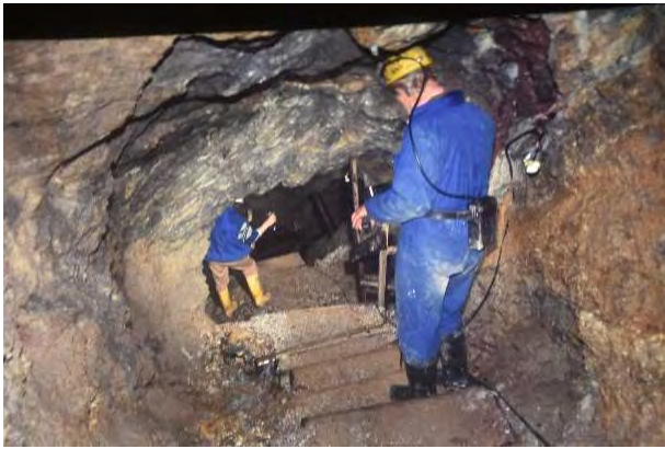
Abb. 4: Wildschönauer Erlebnisbergwerk Thierbach- Lehenlahn: Der Verbindungsaufbruch zwischen Unterbau und Oberbau (Foto und Archiv Peter Gstrein, Innsbruck)
