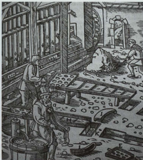
Abb. 5. Pochwerk in Georg Agricola „Zwölf Bücher vom Berg- und Hüttenwesen“, Berlin 1928, p. 279. (Crushing mill from the German translation of Georg Agricola's De Re Metallica , Berlin 1928, p. 279.)
