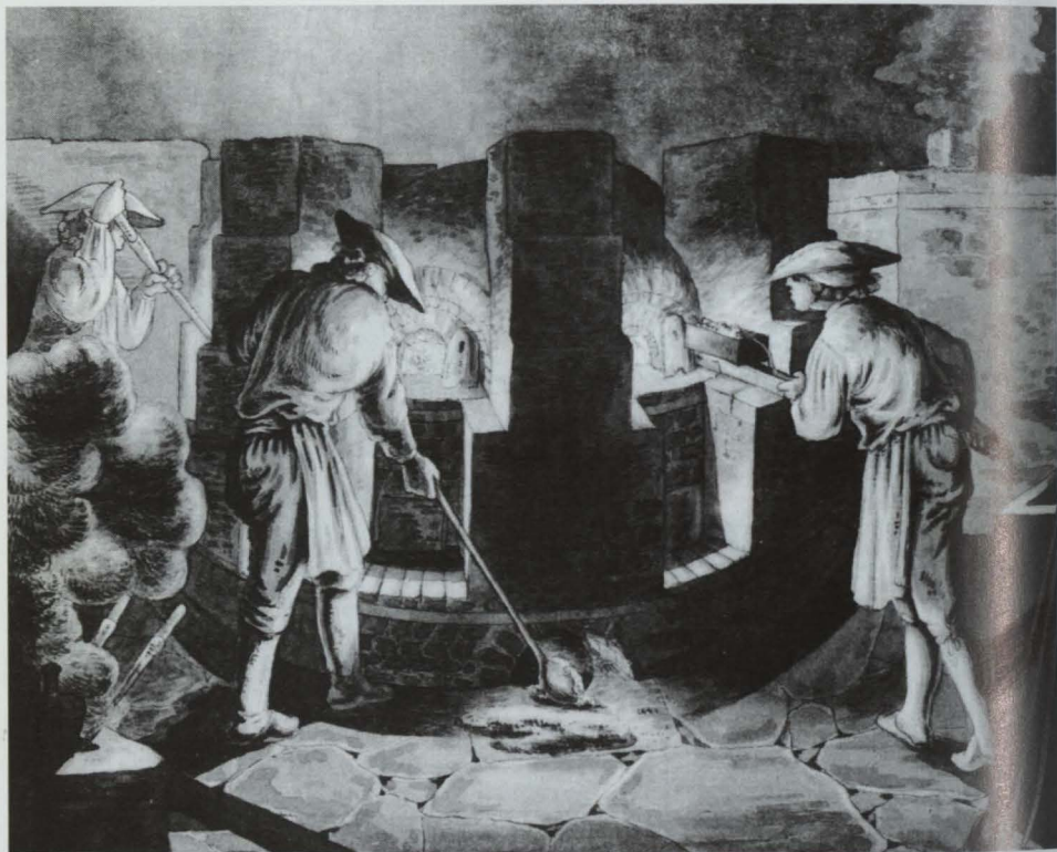
Abb. 4. Die harte Arbeit unter sengender Hitze am Glühofen. Das Schmelzen der Smalte wurde in Häfen aus Ton bei 1100 bis 1250°C vorgenommen. Der Hüttenmann rechts beschickt den Ofen, links wird die glühende Smalte entnommen (Winckler, 1790). (The tough work at the furnace at temperatures of 1100 to 1250°C.)
