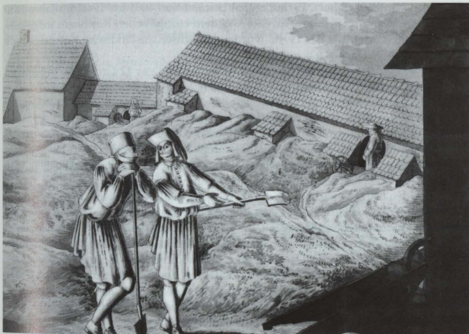
Abb. 5. Die große Menge des angefallenen Giftmehls (Arsenikoxyd: \text{As}_2\text{O}_3 ), das sich in den Rauchkammern gesammelt hat, wird von den Arbeitern mit Mundschutz herausgeschaufelt (Winckler, 1790). (The large amount of poisonous arsenic oxide from the smoke chambers is removed by workers with mouth protection.)
