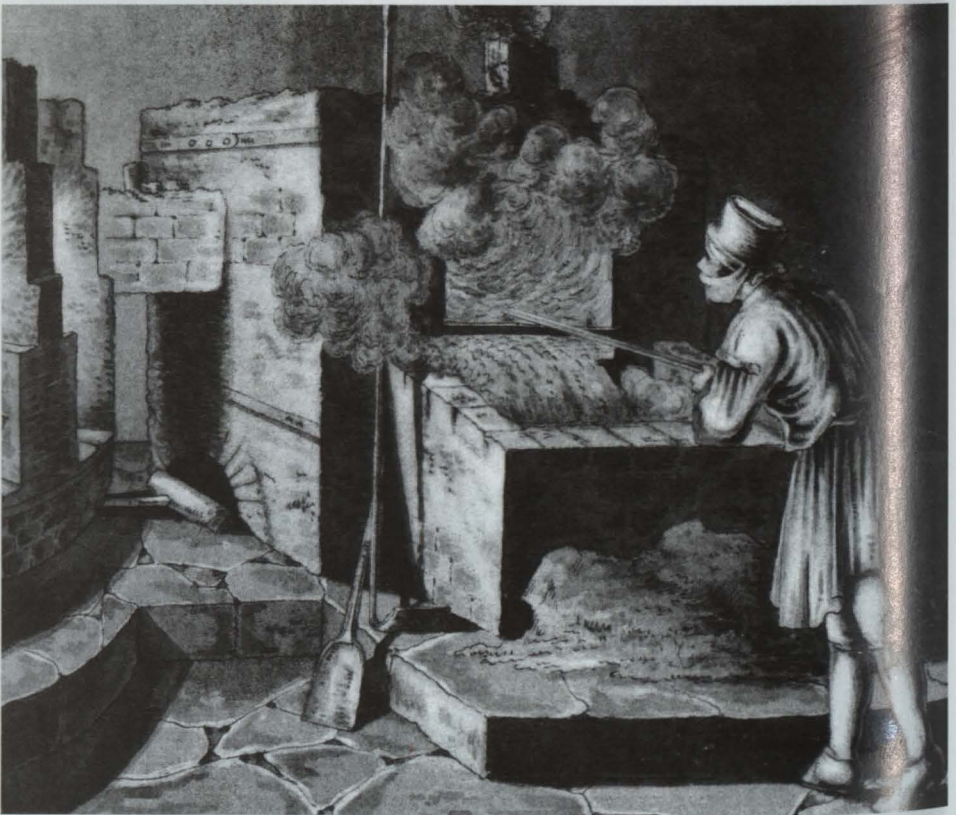
Abb. 2. Die gesundheitsschädigende Arbeit am Flammofen, dort wo der Röstprozeß, die Entfernung von Schwefel und Arsen unter Bildung von Oxyden stattfindet (Winckler, 1790). (The unhealthy work at the furnace, where the sulphur and arsenic is removed and the oxides are formed, the so-called roasting.)
